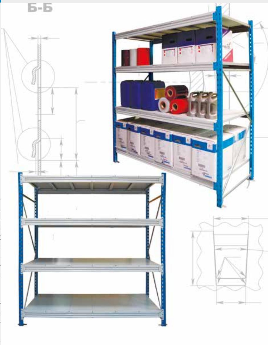
Усовершенствованная стеллажная конструкция, состоящая из рам (сборная конструкция из двух стоек, соединенных горизонтальными и наклонными стяжками), продольных балок с креплением к стойкам на зацепах и металлических настилов, размещенных на продольных балках. Ярус хранения включает в себя две балки и настил
